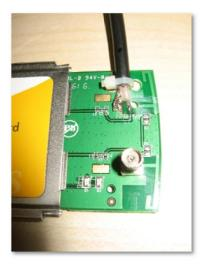
Ho quindi deciso di effettuare un ulteriore modifica e ho riaperto la Pc Card questa volta per interrompere anche la seconda antenna interna e saldare un cavo coassiale direttamente sul circuito stampato.
