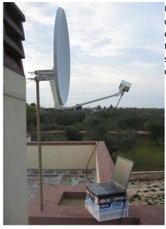
Utilizzando il portatile ho collegato la parabola per valutare la forza del segnale in ricezione, e nonostante l'antenna non è ancora definitiva e nonostante la polarizzazione sbagliata (l'emittente trasmette in pol. orizzontale mente la parabola e in pol. verticale) il segnale ricevuto non presenta più quelle irregolarità nel grafico come nella prima prova.
